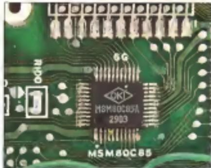
La sezione di microprocessore MS 85. Questi chip, installato in un unico CMO2 (due package) in ogni set di una serie controller grafici.
